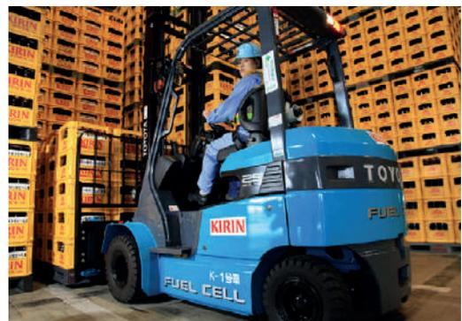
Figura 23: Montacarga en base a celdas de combustible.
