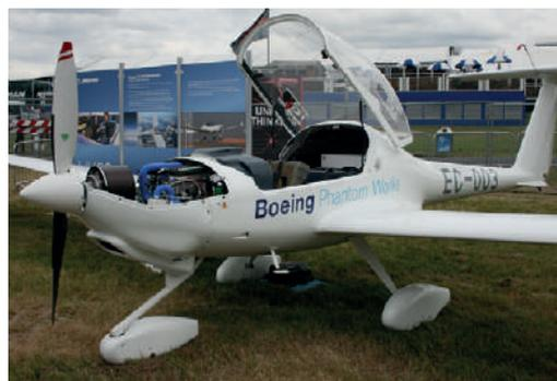
Figura 24: Demostración de celdas de combustible Boeing (Diamond HK36 Super Dimona EC-003) exhibido en Farnborough Airshow 2008.
