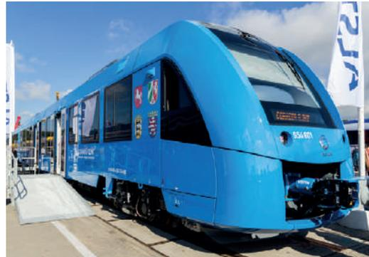
Figura 18: Tren Coradia iLint utiliza hidrógeno como combustible.
